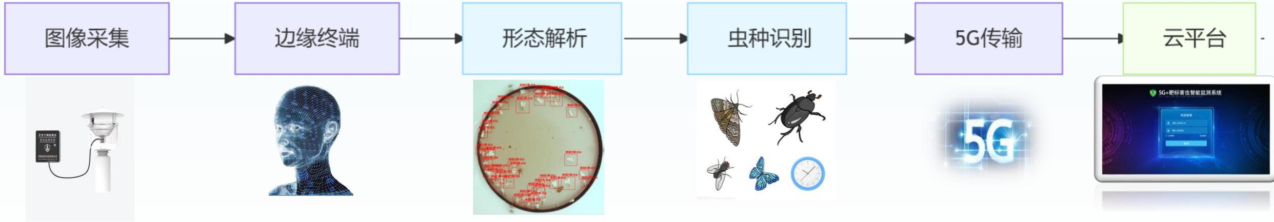
本系统搭载**智能边缘计算终端**。基于深度学习的图像识别算法对诱捕目标进行毫秒级处理，实现虫情种类的**精准鉴别**，经**国家级检测机构验证**，目标虫种识别准确率稳定在**95%**以上，拥有**多项专利和奖项**。结合5G网络将结构化虫情数据回传至智能测报云平台，构建“端-边-云”协同的智慧决策中枢，为目标区虫害动态可视化与精准施治提供核心算法支撑。
