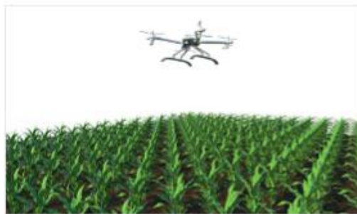
田间无人机式高通量植物表型采集 分析平台
