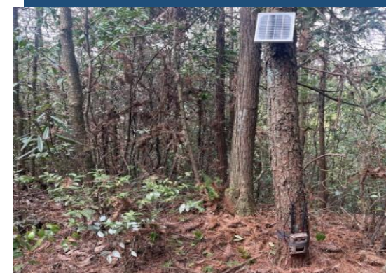
哺乳动物智慧监测 (实时传输红外相机+太阳能供电板)
